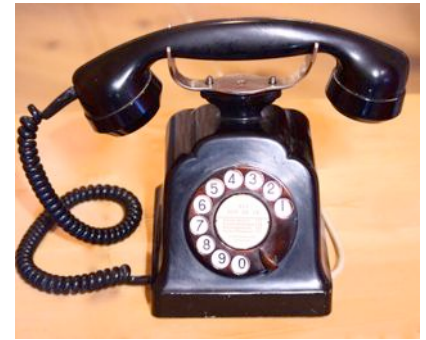
Tischtelefon von 1928, Modell PTT, mit Wählscheibe. Zum Telefonieren musste man den „Hörer“ von der „Gabel“ „abheben“, nach dem Gespräch „auflegen“. FOTO: LDs
